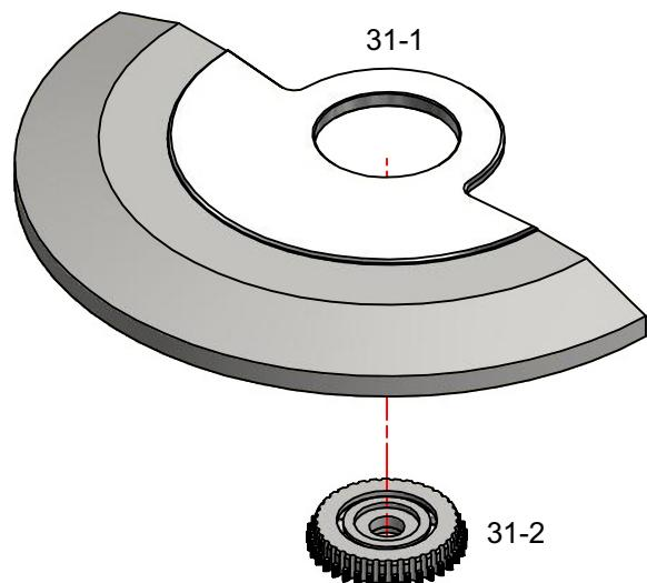
**Montage mouvement – Werkmontage – Assembling of the movement****Roue entraîneuse sur roue moyenne – Mitnehmerrad auf Kleinbodenrad – Driving wheel over third wheel**
